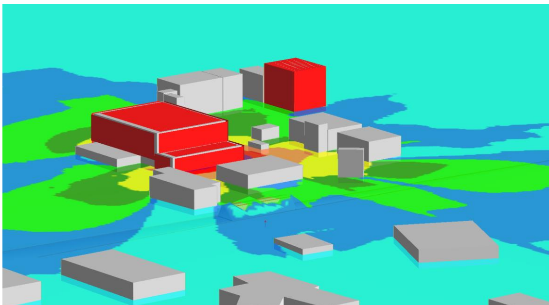
Figure n°3. Simulation du bâtiment principal (sources rayonnantes surfaciques)
